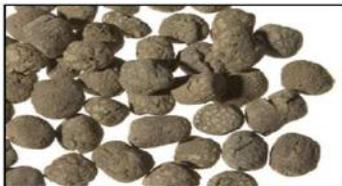
foto: agregados de argila expandida ; pesos do betão inferiores a +- 30 a 40% m3
