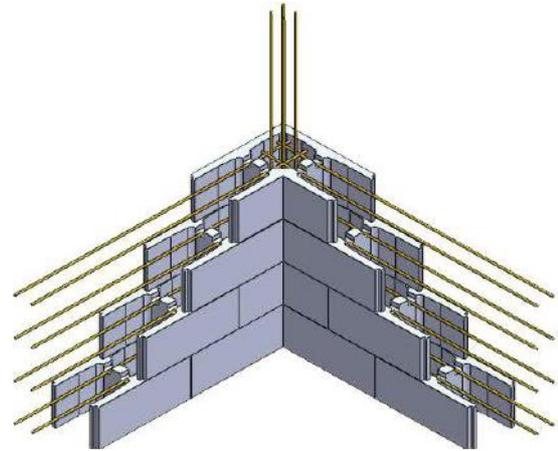
foto: parede reforçada de sustentação de terras
